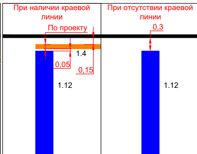
Отступ линии 1.13 от борта при ширине полосы проезжей части кратной 0,5 м
